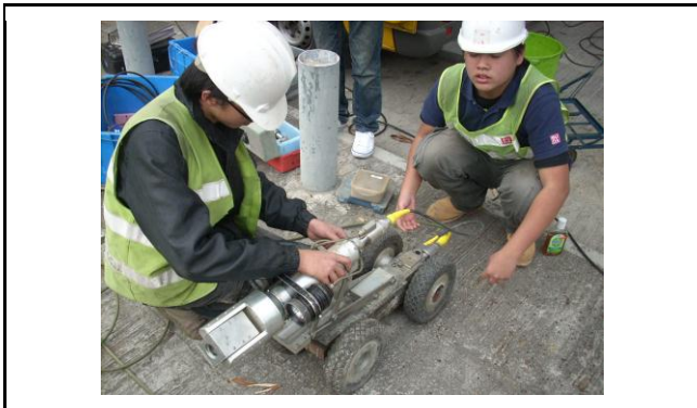
Fig.1 Assemble the CCTV components 圖一. 組合閉路電視部件。
